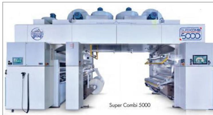
Presso il reparto M2 sono utilizzate n. 3 macchine accoppiatrici della Nordmeccanica S.p.A. le quali hanno sempre lo scopo di accoppiare un film neutro con un film stampato, per garantire l'alimentarietà dell'imballaggio. Anche presso M2 si prevede di introdurre una nuova macchina per l'accoppiamento ad elevata tecnologia. Queste macchine presentano:
