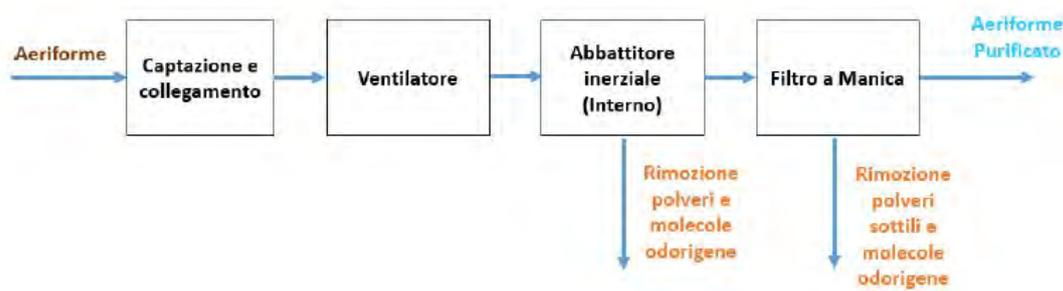
Le emissioni sono captate sulla tramoggia e bocca del trituratore come rappresentato nella Tav emissioni in atmosfera, da un apposito sistema di cappe con chiusure perimetrali in gomma trasparente, convogliate all'impianto di trattamento mediante idonee tubazioni di collegamento.
