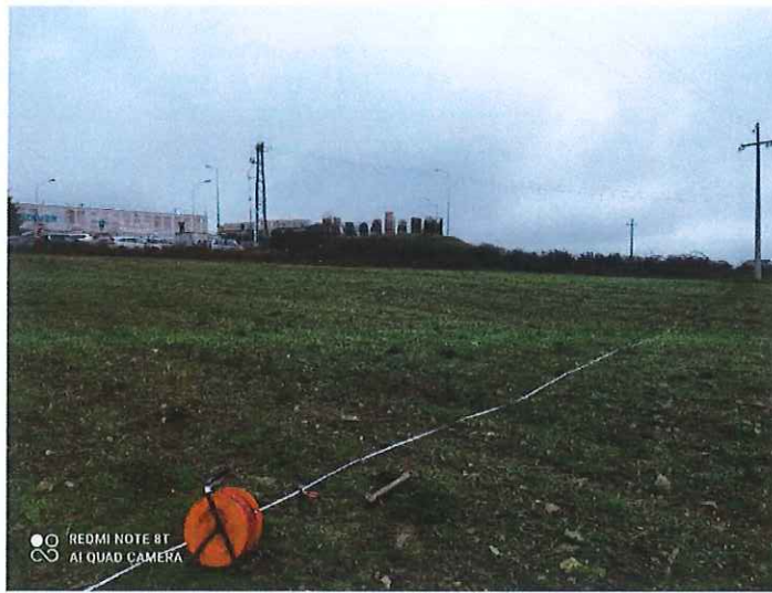
Indagine geoelettrica SEV1
