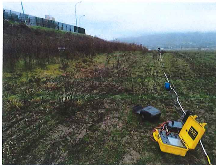
Indagine geoelettrica SEV1
