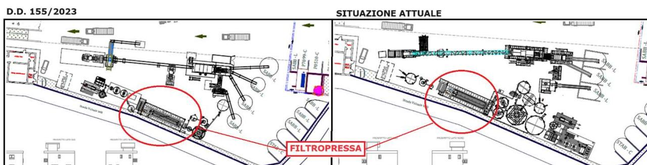
La variazione del posizionamento della filtropressa è stata necessario al fine di agevolare il passaggio dei mezzi pesanti operanti nel sito produttivo ed efficientare il processo di chiarifica e trattamento dei contaminanti presenti nel materiale da riciclare.
