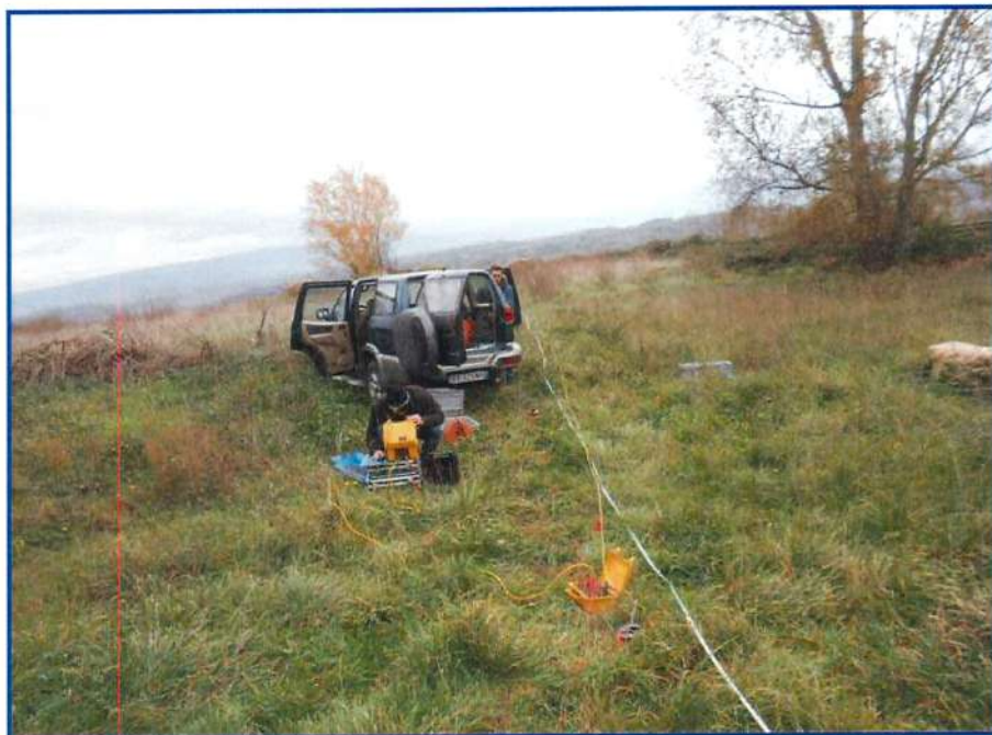
Fig. 2 – Stendimento multielettrodico n.2 effettuato presso la discarica comunale di Montemiletto (AV). Tomografia geoelettrica C-D. 32 elettrodi di misura, spaziatura elettrodica 2.2m. Lunghezza complessiva stendimento 68.2m.
