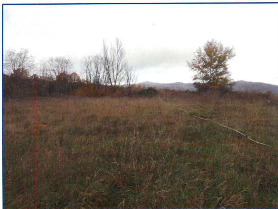
Fig. 3 – Stendimento multielettrodico n.3 effettuato presso la discarica comunale di Montemiletto (AV). Tomografia geoelettrica E-F. 32 elettrodi di misura, spaziatura elettrodica 1.7m. Lunghezza complessiva stendimento 52.7m.
