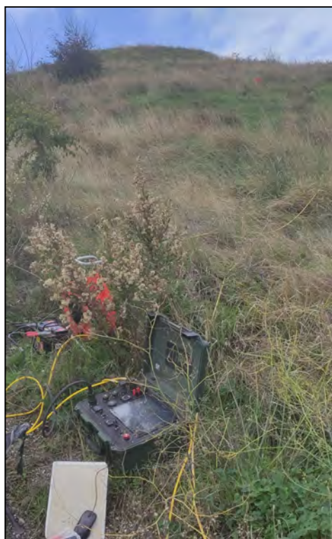
Fig. 2 – Stendimento multielettrodo n. T2a effettuato presso la discarica comunale di Montecalvo Irpino. Tomografia geoelettrica T2a. 32 elettrodi di misura, spaziatura elettrodoica 3.0m. Lunghezza complessiva stendimento 93.0m.
