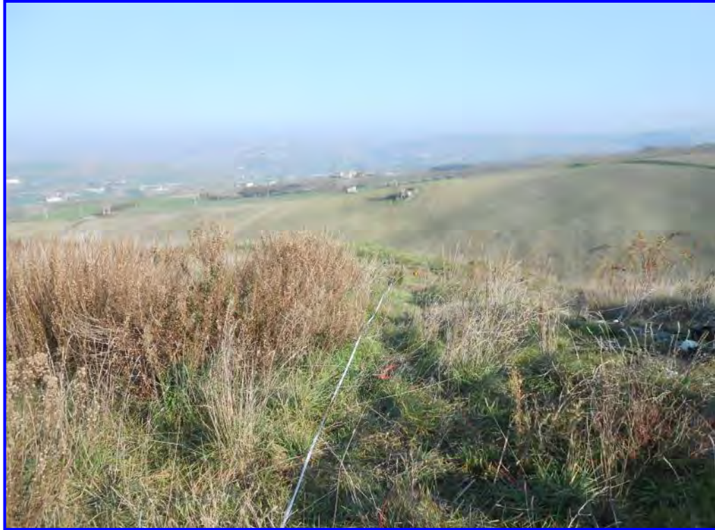
Fig. 1 – Stendimento multielettrodo n.1 effettuato presso la discarica comunale di Montecalvo Irpino. Tomografia geoelettrica A-B. 32 elettrodi di misura, spaziatura elettrodoica 4.5m. Lunghezza complessiva stendimento 139.5m.
