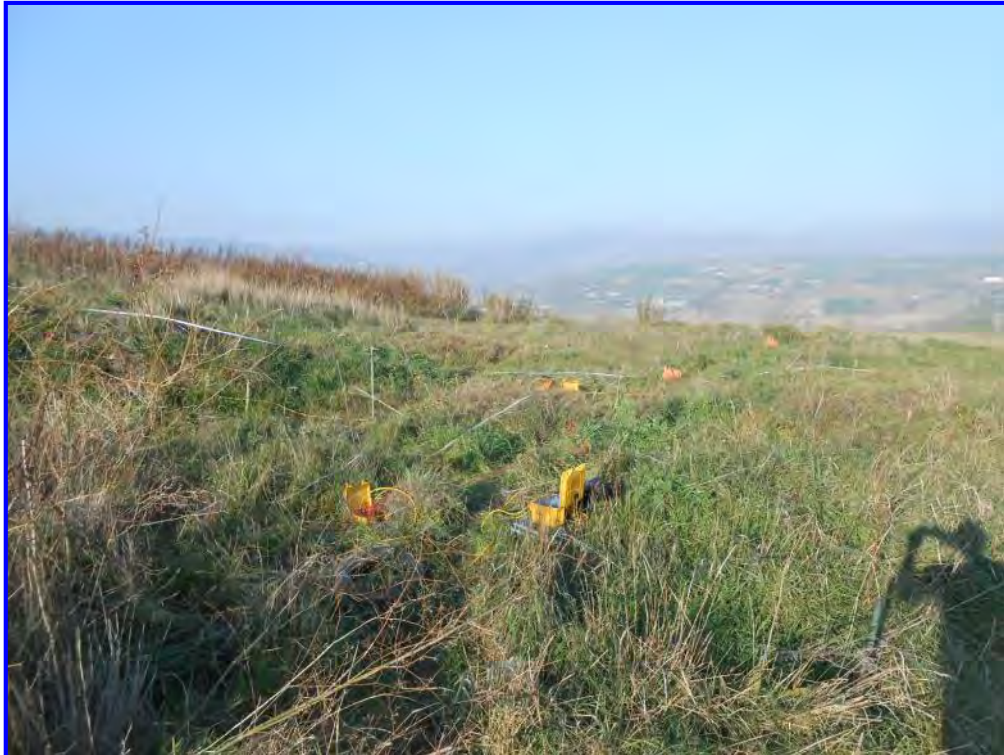
Fig. 3 – Stendimento multielettrodo n.3 effettuato presso la discarica comunale di Montecalvo Irpino. Tomografia geoelettrica E-F. 32 elettrodi di misura, spaziatura elettrodoica 1.0m. Lunghezza complessiva stendimento 31m.
