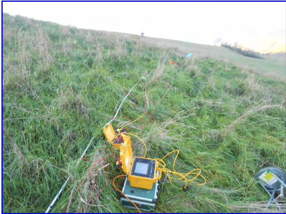
Fig. 4 – Stendimento multielettrodo n.4 effettuato presso la discarica comunale di Montecalvo Irpino. Tomografia geoelettrica G-H. 24 elettrodi di misura, spaziatura elettrodoica 1.0m. Lunghezza complessiva stendimento 23m.
