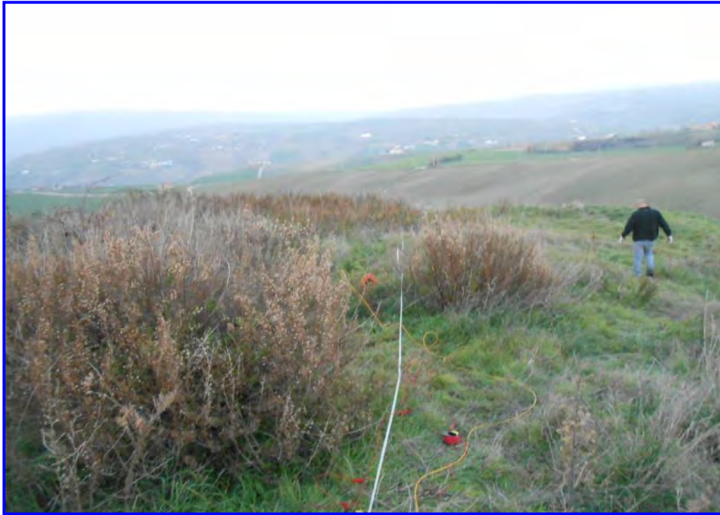
Fig. 2 – Stendimento multielettrodo n.2 effettuato presso la discarica comunale di Montecalvo Irpino. Tomografia geoelettrica C-D. 24 elettrodi di misura, spaziatura elettrodoica 1.0m. Lunghezza complessiva stendimento 23m.
