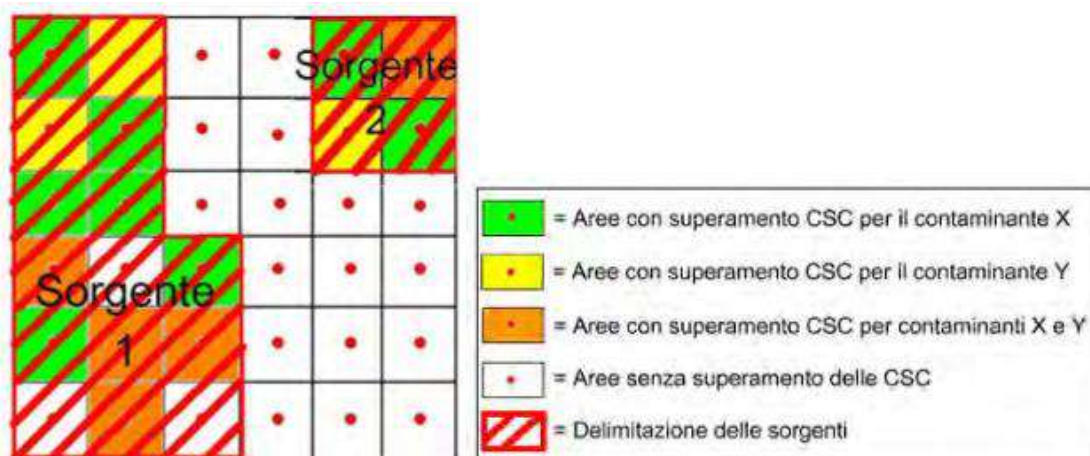
Figura: schema di campionamento sistematico a maglia regolare
