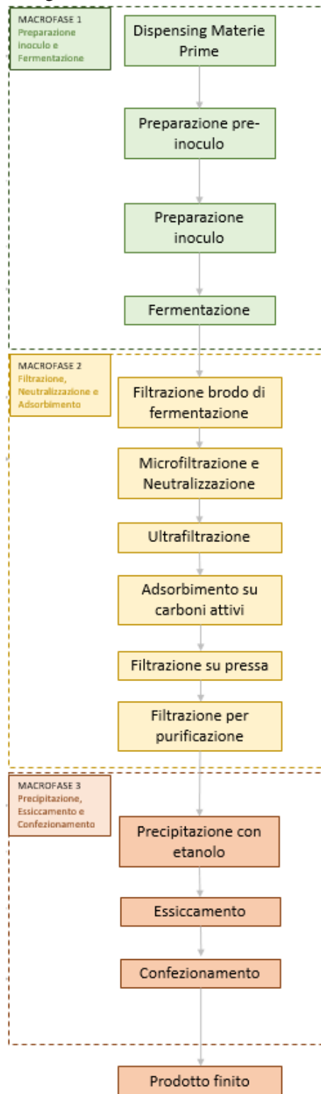
Figura1- Schema a blocchi del processo -API-Acido ialuronico
