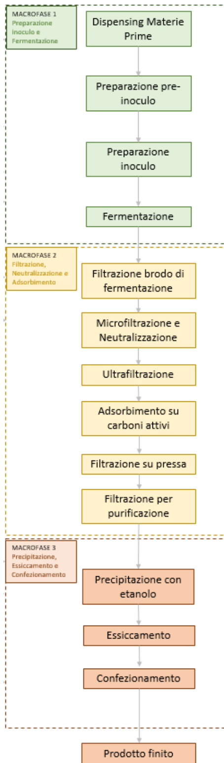
Figura1- Schema a blocchi del processo -API-Acido ialuronico
