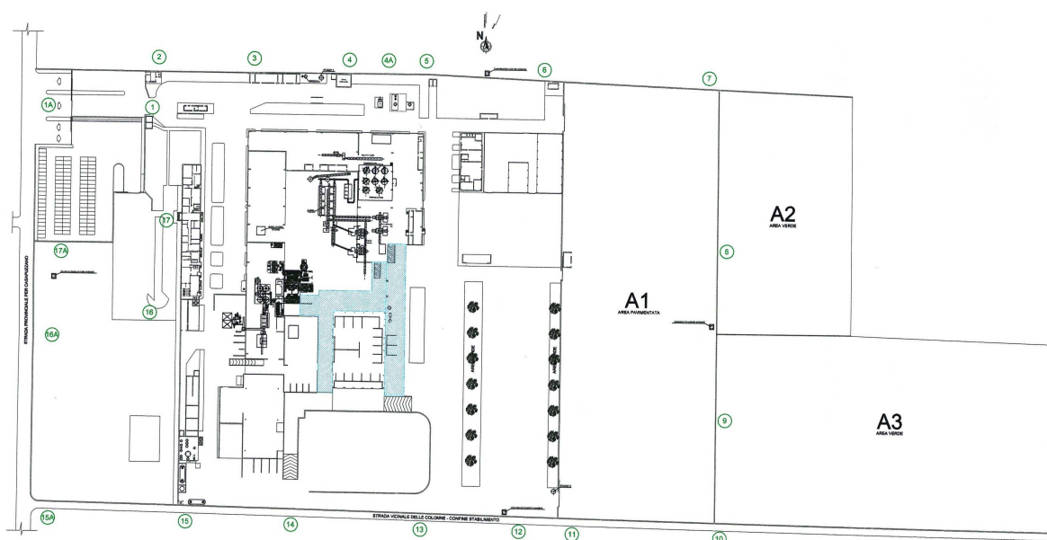
Figura C.1 Individuazione punti di misurazione delle emissioni sonore
