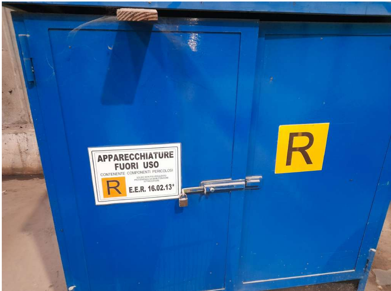
Foto n. 3: n. 1 contenitore contenente n. 1 apparecchiatura fuori uso. Per tale tipologia di rifiuto è presente etichettatura riportante il relativo codice EER 160213* e lo stato fisico, ma non le specifiche caratteristiche di pericolosità
