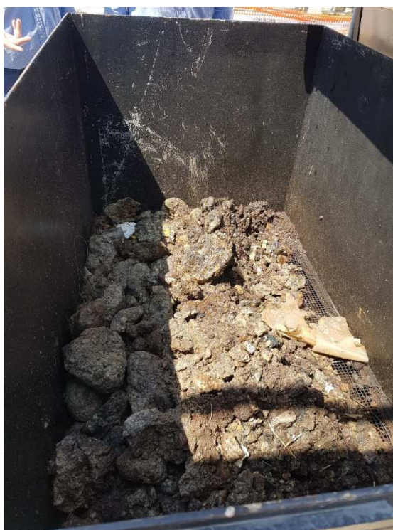
Figura 2.8.5 – Residuo solido fase di grigliatura in ingresso al TAF
