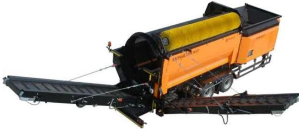
Figura 20 - Vaglio rotante tipo
