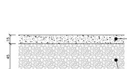
PAVIMENTO INDUSTRIALE "SISTEMA A SPOLVERO" REALIZZATO IN CALCESTRUZZO CON CLASSE DI RESISTENZA C20/25 E CLASSE DI CONSISTENZA S4, DELLO SPESSORE DI 15 CM, ARMATO CON R.E.S. # 8 MM MAGLIA 20x20 CM. E' PREVISTA LA FORMAZIONE DI GIUNTI DI DILATAZIONE A RIQUADRI DI 9 - 10 MQ CON IDONEA FRESATRICE MECCANICA E SUCCESSIVA SIGILLATURA CON GUARNIZIONI IN PVC O RESINA.
