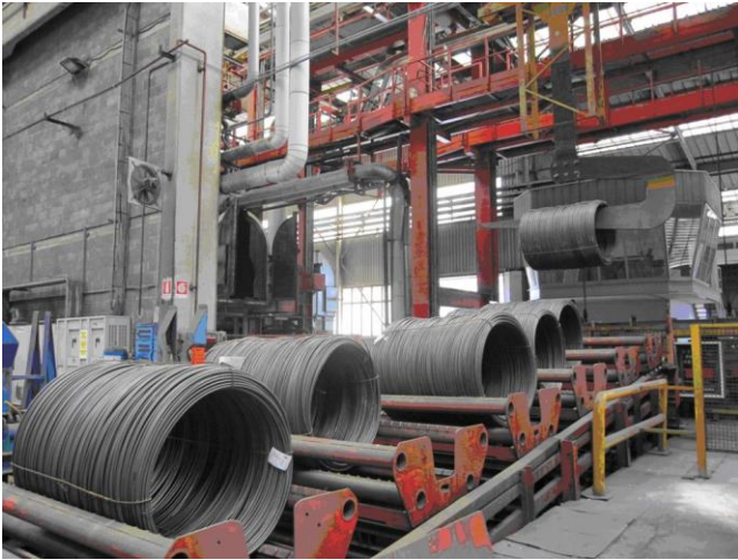
Figura B.1 – Carico vergella all'impianto di decapaggio
